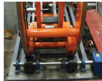
El Clamping és l'utilatge per a subjectar i girar les virolles mentre es solden
