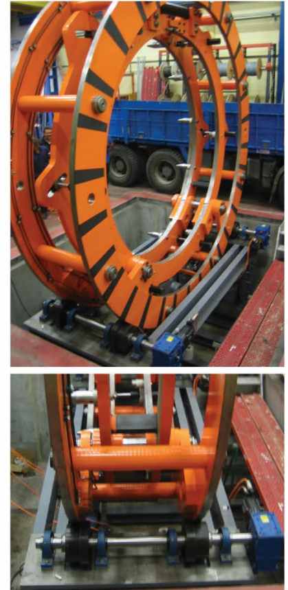
El Clamping és l'utilatge per a subjectar i girar les virolles mentre es solden
